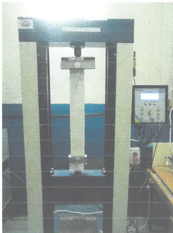
Рисунок 2 – Кріплення дослідного зразка в захватах машини випробувальної МРМ-5Т під час випробування
