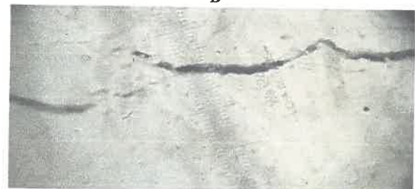
Рисунок 3 – Типові тріщини, характерні для випробувальних зразків
